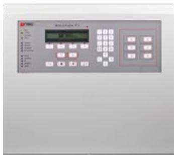
Centrale antincendio modulare, per rilevatori analogici indirizzabili e rilevatori convenzionali. Predisposta per **2-6 loop** fino a 1.542 indirizzi e/o 8-24 zone convenzionali. Supporta i rilevatori Hochiki ESP e CDX e Apollo Orbis, XP95, Discovery e Soteria.
