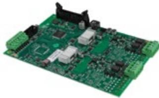
**Scheda Loop Multiprotocollo per il Sistema F1**
