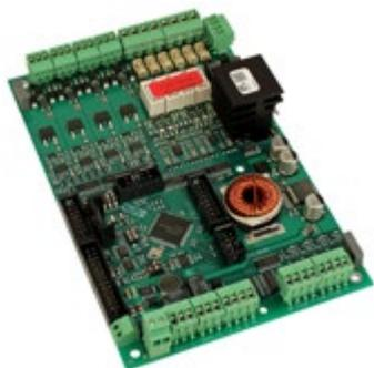
**Scheda di controllo spegnimento P129 per Solution F2, una zona di spegnimento, conforme alla norma EN12094-1**
