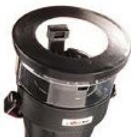
**Unità per test su rilevatori di calore "Solo 460" (a batteria)**
