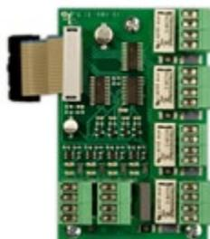
**Estensione – Standard Extinguishing Interface (SST) per Schede di Controllo per Sistemi di Spegnimento, estensioni I/O**
