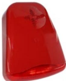
**Sirena convenzionale autoalimentata, installazione in superficie, con lampeggiante, potenza acustica 100dB/1m, IP33**
