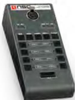
L'MCS-8B è una potente stazione di chiamata multizona da utilizzare con i sistemi di allarme vocale MILO & BOX 500. Possono essere collegate all'ACSI-BUS del MILO sistema / BOX 500 fino a 8 postazioni annunci multizona MCS-8B. Il collegamento previsto è in daisy chain, con un cavo CAT5.
